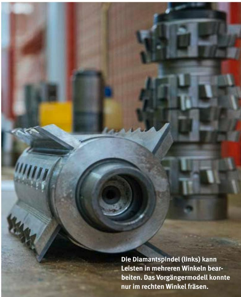
Die Diamantspindel (links) kann Leisten in mehreren Winkeln bearbeiten. Das Vorgängermodell konnte nur im rechten Winkel fräsen.
